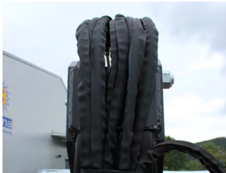
Schlauchbruchschutz im Bedienerbereich serie
