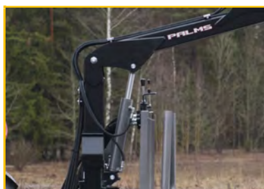
gut dimensionierte, hohe Kransäule mit starkem Haupthubzylinder
