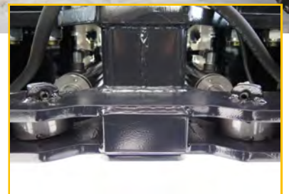
2 starke Knickdeichsel- zylinder
