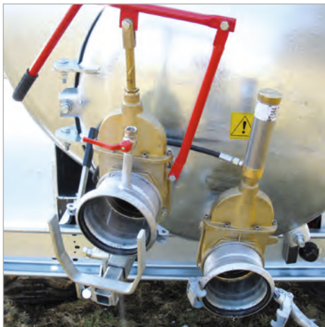
4", 6" oder 8" Handschieber mit Schnellkuppler und 4", 6" oder 8" Hydraulischschieber
