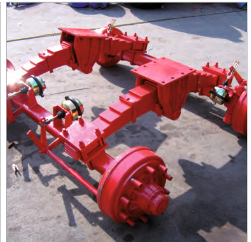
Bogieaggregat mit Lenkachse
