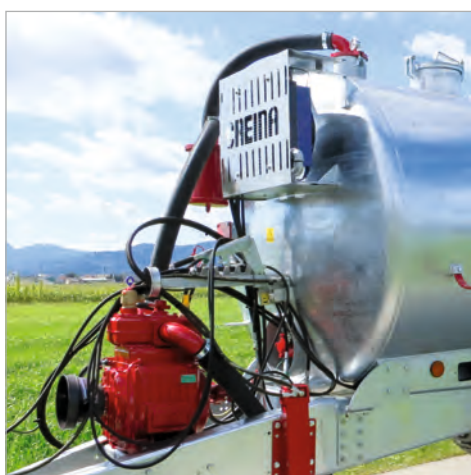
Kompressor der Serie WPT mit Wasserkühlungsanlage
