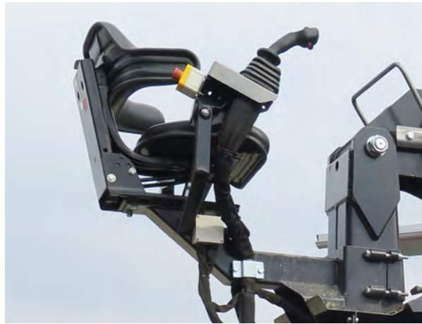
Hochsitz (nur in Verbindung mit Prehydrauliksteuerung möglich)
