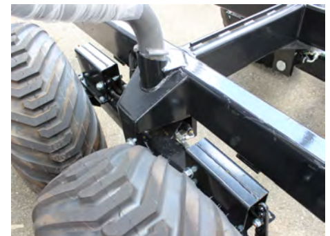
hydraulische 4-Rad Bremse (auch als Druckluftausführung erhältlich)
