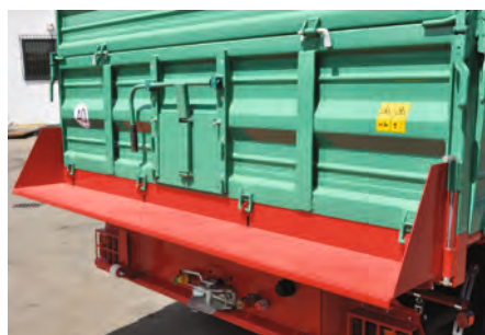
Auslaufrutsche über die gesamte Breite - hinten Abnehmbarer Beleuchtungsschutz
