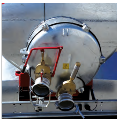
hinten Fassdeckel \varnothing 900 ab 6000 l Fässer
