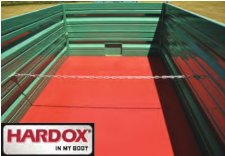
Selbstreinigender 4 mm starker HARDOX Brückenboden
