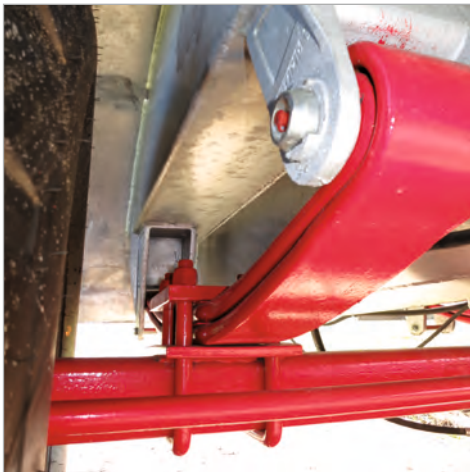
Einzelachsaggregat mit Parabelfedern
