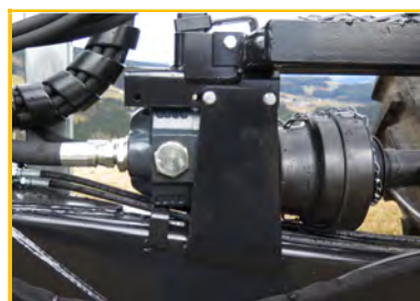
robuste, langlebige Gusspumpen bei Eigenölversorgung
