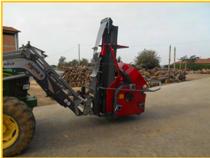
leichter Transport mittels Palettengabel möglich
