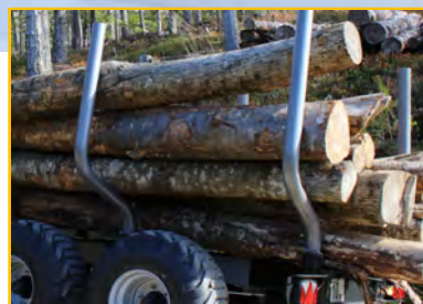
extrem massive und hohe Rungen aus Spezialstahl
