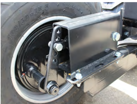
hydraulische Bremse (Serie bei allen Palms Anhängern)
