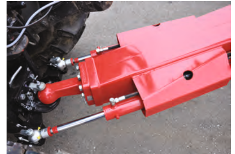
Untenanhängung samt Scharmüller Kugelkupplung K80 und Zwangslenkung für hohen Fahrkomfort und Verschleißschutz
