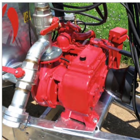
Pumpe der Serie GARDA (Kompressor + Kreislumpumpe)
