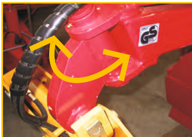
stabiles Pendelscharnier: Zange kehrt immer in Ausgangsposition zurück
