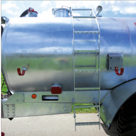
Leiter und Öffnung \varnothing 300 an der Oberseite des Tanks
