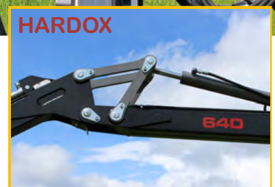
stabiles Weitwinkelgelenk massiver Teleskopausleger
