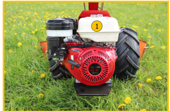
Honda Bergmotor 9 Ps mit Kraftstoffförderpumpe am Motormäher Alpin Profi sowie Profi Plus
