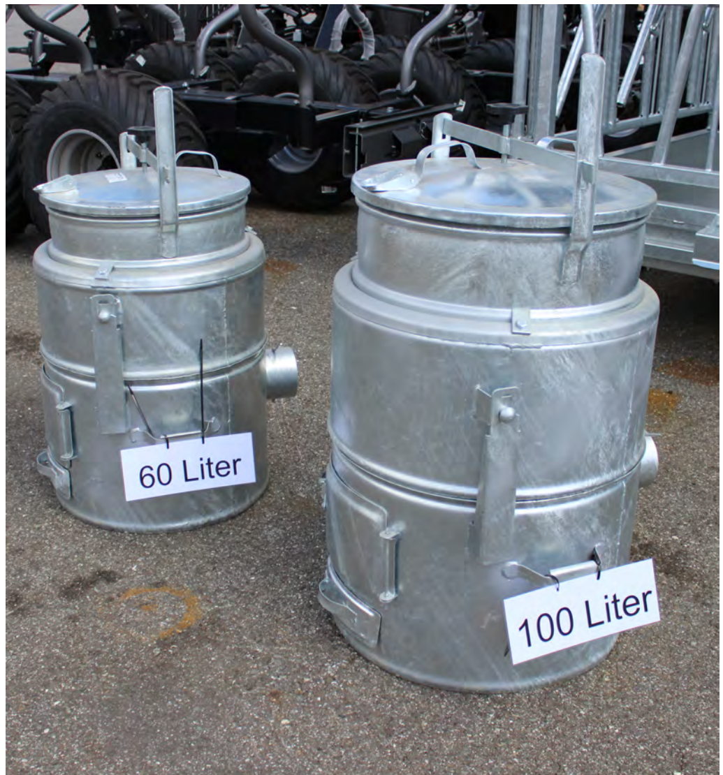
SOMA Futterdämpfer: kippbar und mit Tragegriffen ausgestattet
