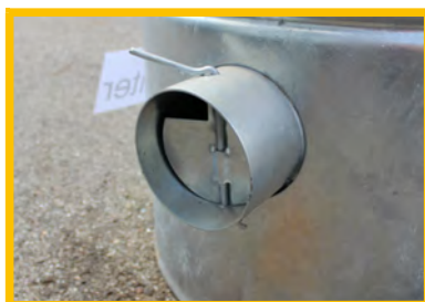
regulierbare Abzugsklappe im Rauchrohr
