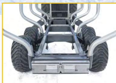
robuster, verwindungssteifer Doppelrahmen
