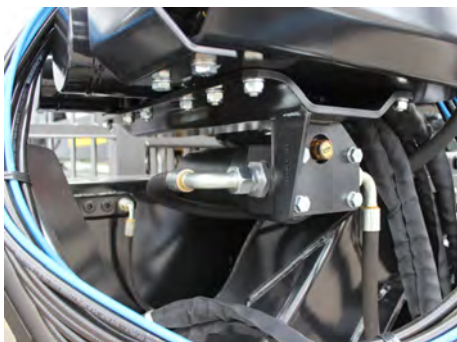
Druck-Ölfilter bei allen Kränen mit Funk-, Prehydraulik- oder EHC-steuerung
