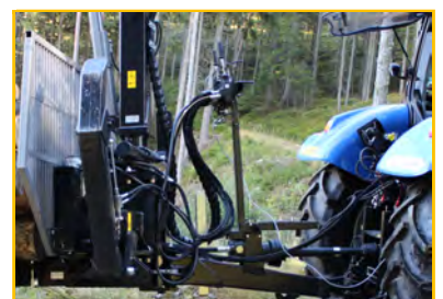
Optional: Stehpodest mit Steuerblockhalterung
