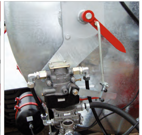
ALB-Regelung zu Druckluftbremse
