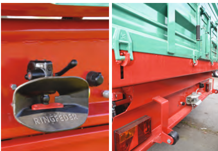
Automatische Anhängenvorrichtung Abrollbügel links und rechts mit Rollen und Flacheisen
