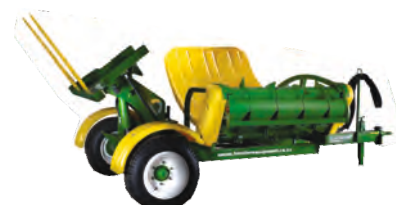
CHAINLESS 4000 gezogener Abwickler ohne Ketten für 2 Ballen
