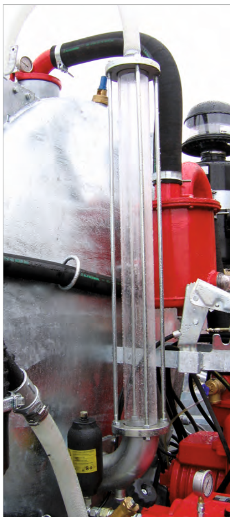
Indexstand Plexiglasrohr 85 mm
