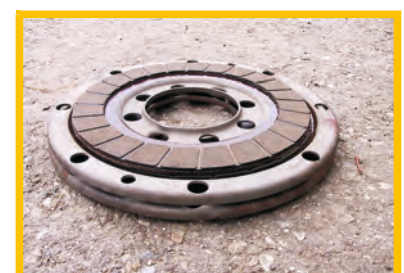
Lamellenkupplung mit 3 bzw. 5 Reibbelägen, der Kupplungsbelag ist mit einem Spezialkleber aufgeklebt
