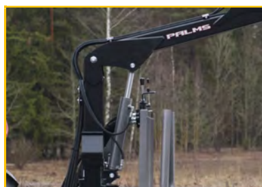
gut dimensionierte, hohe Kransäule mit starkem Haupthubzylinder
