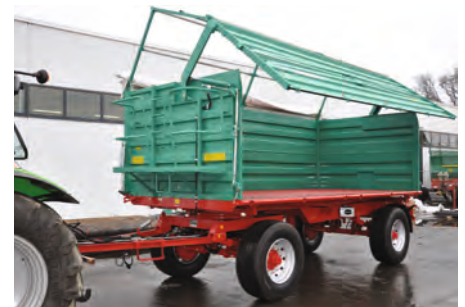
Hydraulische Öffnung der Seitenwand
