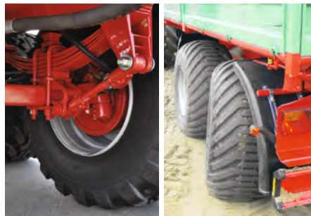
Nachlaufenkachse für optimale Manövrierfähigkeit, bessere Laufleistungen, zur Verminderung des Reifenverschleißes und weniger Kraftstoffverbrauch
