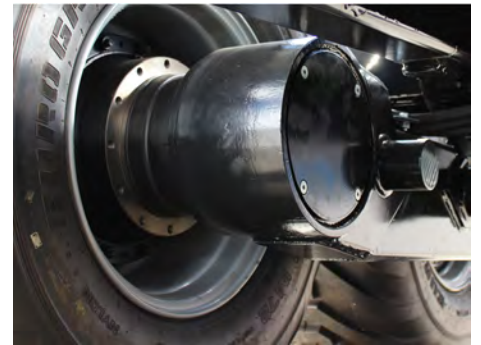
hydraulischer Radnabenantrieb, erhältlich für H9S, H11S, H13D, H15D
