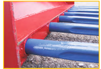
Die Zinken sind mit Konushülsen in einem Profilrohr befestigt.
