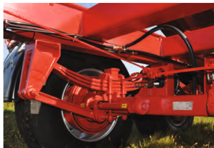
Zweileitungs-Druckluftbremsanlage mit ALB-Regler (automatische lastabhängige Bremskraftregelung) erhöht Stabilität und reduziert das Risiko von Umkippen, Rutschen und Schleudern
