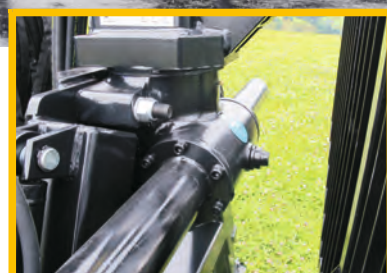
Das stabile Gußgetriebe sorgt für ausreichend Schwenkmoment
