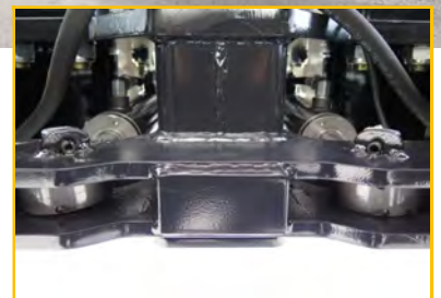
2 starke Schwenkdeichsel- zylinder
