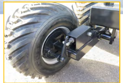
massive Tandem-Pendelachse mit Schutz für die Bremsleitungen
