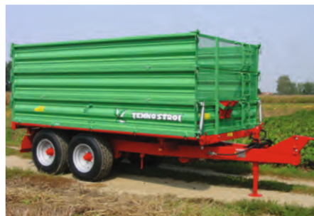
Dritte Aufsatzbordwand vorne als Gitter
