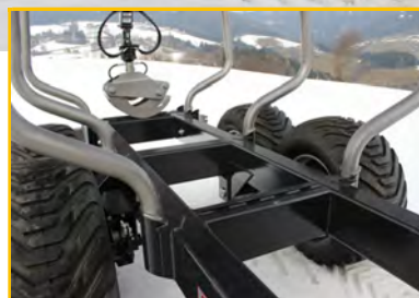
robuster, verwindungssteifer Doppelrahmen
