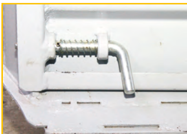
Automatikverschluss der Pendelbordwand
