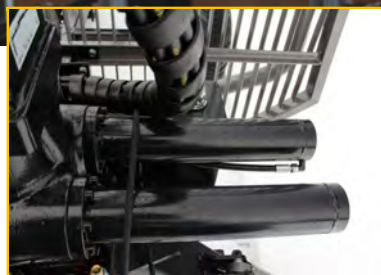
starkes 4-Zylinder Schwenkwerk
