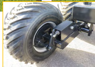
massive Tandem-Pendelachse mit Schutz für die Bremsleitungen
