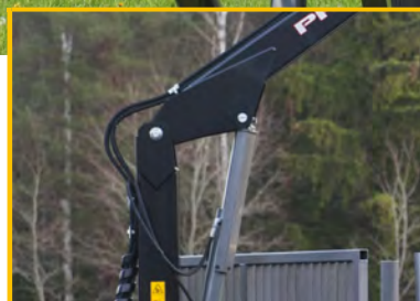
starke Kransäule mit massiver Lagerung
