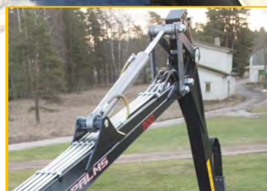
professionelle Verlegung der Hydraulikleitungen
