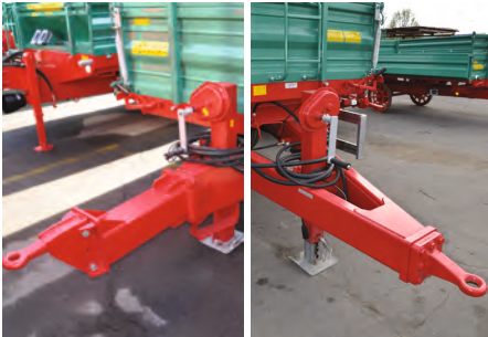
Sattelstützwinde teleskopierbar mit zwei Geschwindigkeiten (dreistufig) Untenanhängung
