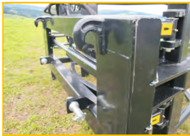
massiver Frontladeranbau (Eurokuppelsystem)
