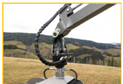
serienmäßig: 30 KN Rotator massives Pendelgelenk
