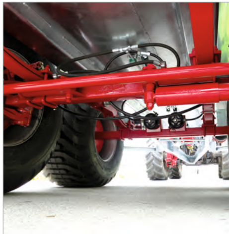
Tandemaggregat mit Parabelfedern
