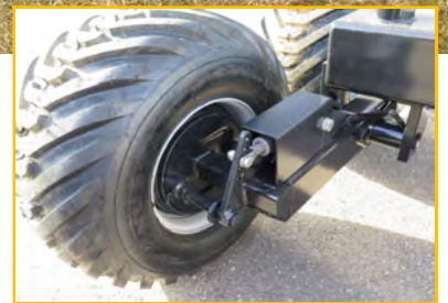
massive Tandem-Pendelachse mit Schutz für die Bremsleitungen
