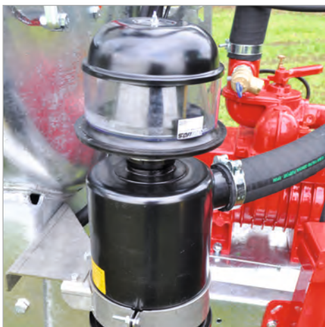
Schalldämpfer mit Ölabscheider
