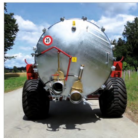
Fassdeckel gesamter Fassdurchmesser bis 6000 l Fässer
