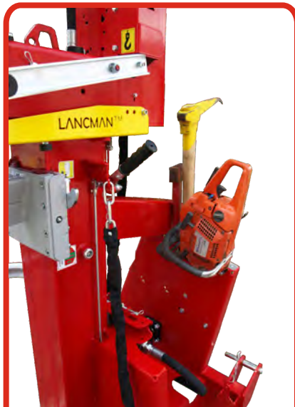
Halter für Motorsäge, Sappi und Spritkanister
