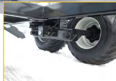
massive Tandem-Pendelachse mit Schutz für die Bremsleitungen
