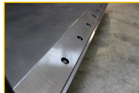
geschraubte Schürfleiste aus Hardox - Stahl
