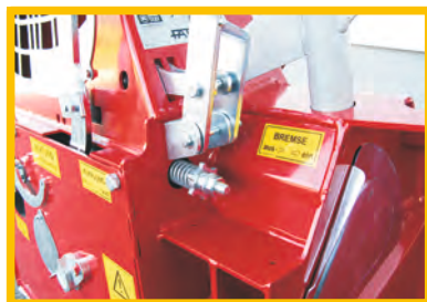
sehr einfache Einstellung der Bremse für den Seilauszug
