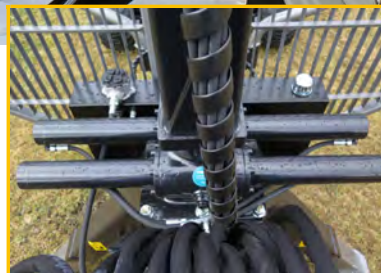
starkes 4-Zylinder Schwenkwerk
