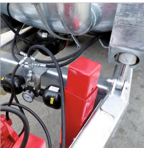
Deichselverstellung mit Deichselfederung
