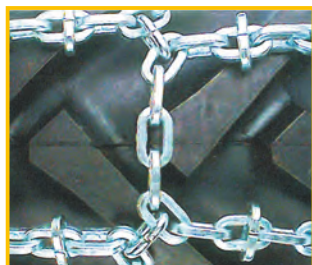
Typ DS: hoher Fahrkomfort; gute seitliche Spurhaltung
