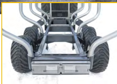
robuster, verwindungssteifer Doppelrahmen
