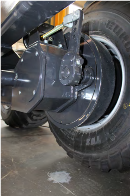
hydraulischer Radnabenantrieb, gebremst
