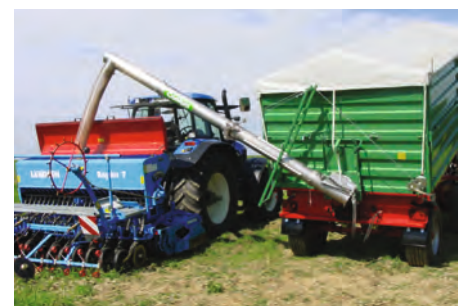
Überladeschnecke - verschiedene Ausführungen (leicht zu montieren, verzinkt oder aus Edelstahl, mit Seilwinde verstellbar, klappbar)
