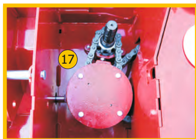
ein Untersetzungsgetriebe sorgt für eine optimale Seileinlaufgeschwindigkeit, (min. 25,2 m/min)
