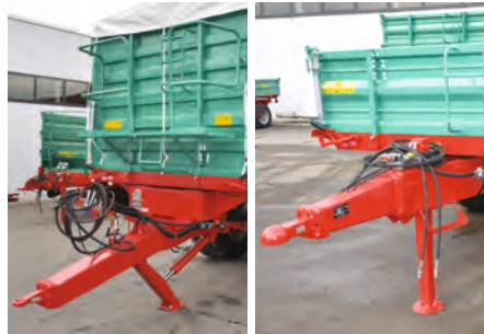
Stützfuß hydraulisch in Y-Variante Stützfuß hydraulisch mit Scharmüller Kugelkupplung
