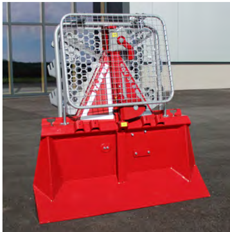
Das Schutzgitter ist abklappbar. Dies ist ein großer Vorteil für die Lagerung u. den Transport
