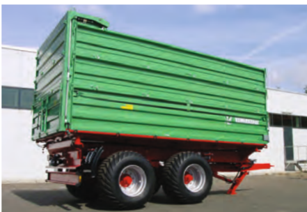
Silagerückwand hydraulisch mit 3. Aufsatz Verstärkte Bordwände
