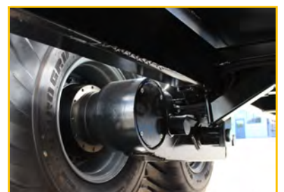
Optional: leistungsstarker Radnabenantrieb
