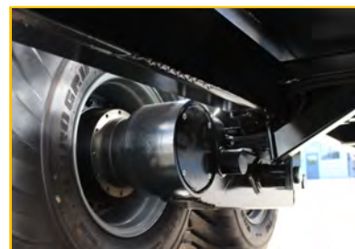
Optional: leistungsstarker Radnabenantrieb
