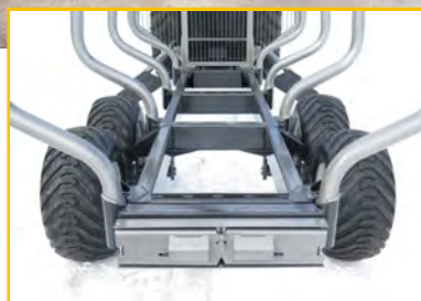
robuster, verwindungssteifer Doppelrahmen
