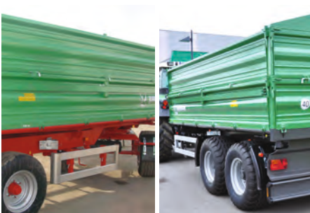
40 km/h Ausführung - Kotflügel und Unterfahrschutz Seitenanfahrschutz bei 40 km/h für Österreich
