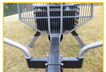
stabiler Zentralrohrrahmen, Achse verstellbar
