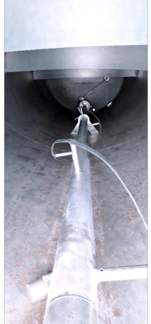
Rührwerk mit Hydraulikmotor
