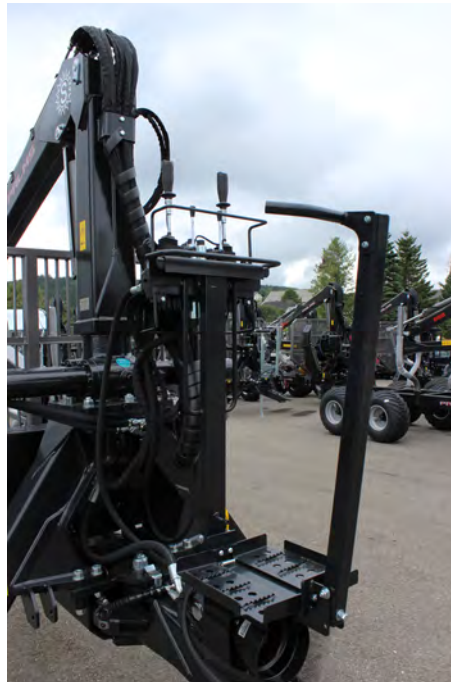
NEU: Stehpodest, aufklappbar, mit anklappbarer Absturzsicherung
