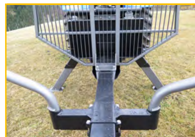
stabiler Zentralrohrrahmen, Achse verstellbar
