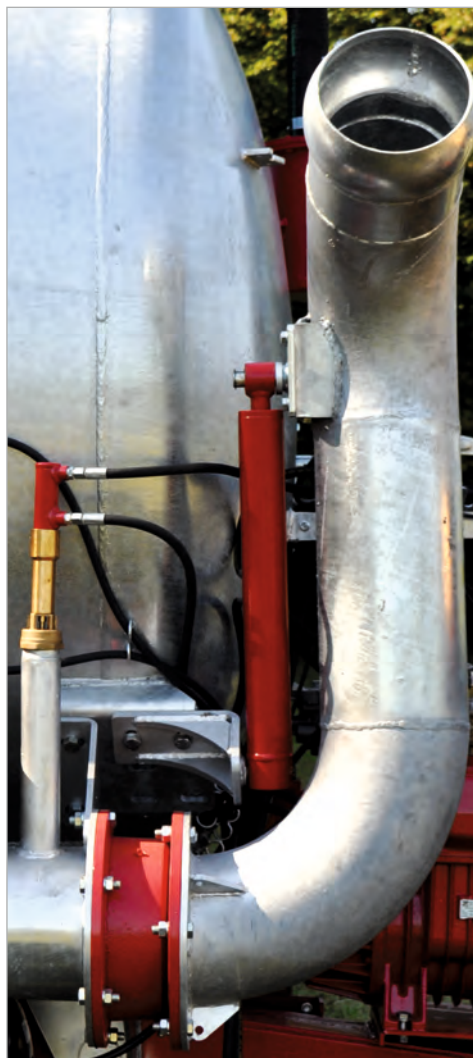
6" oder 8" hydraulischer Saugarm
