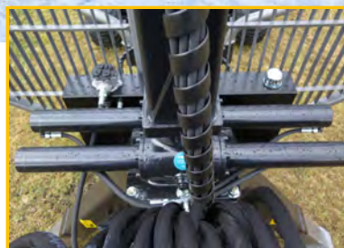
starkes 4-Zylinder Schwenkwerk
