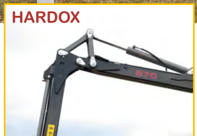
stabiles Weitwinkelgelenk massiver Teleskopausleger
